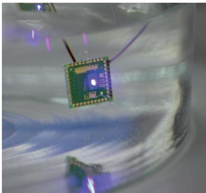
**Um elektronische Chips und Systeme vor rauen Umweltbedingungen und Beschädigungen zu schützen und ihnen einen biokompatible Ummantelung zu geben, beschichten die Forscher am Fraunhofer ENAS diese Systeme mit Parylene®. Auf der HANNOVER MESSE demonstrieren sie die Funktionalität dieser Beschichtung am Beispiel von elektronischen Chips – hier mit integrierte LED – unter Wasser.**
