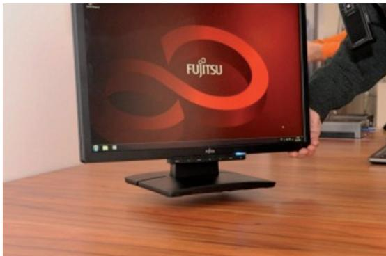
**Der von Fujitsu zur Verfügung gestellte Monitor wurde mit der WiTech-Empfängereinheit ausgestattet und erhält Strom und Daten direkt über die Tischplatte des Büromöbels. Das WiTech-System ermöglicht eine freie Platzierung des Monitors auf dem Tisch.**
